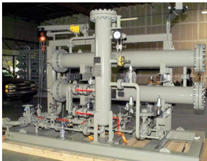
Skid membranowy do uzdatniania gazu paliwowego firmy Membrane Technology and Research w Newark w Kalifornii, zainstalowany na platformie wiertniczej u wybrzeży Kataru
